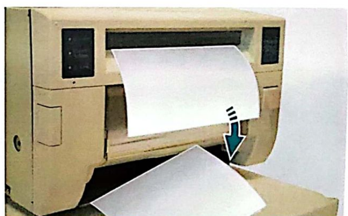
21. Des photos vierges sont imprimées automatiquement pour confirmer le bon fonctionnement de l'imprimante.
