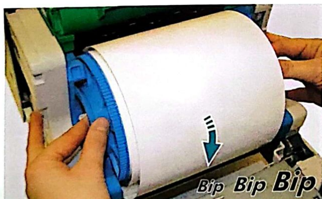
14. Dérouler le papier dans la fente, entre les galets blancs et le support noir, jusqu'à entendre les «bip»sonores.
