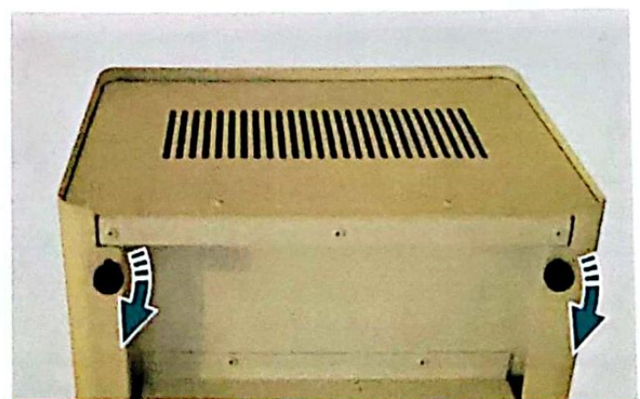
23. Revisser les deux vis à mollettes, en dessous du boîtier de l'imprimante.
