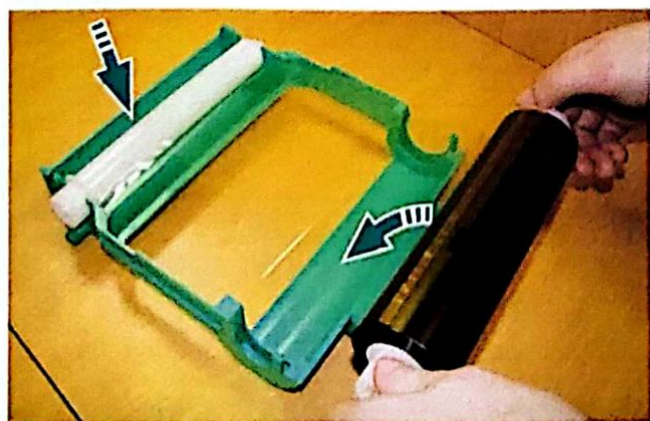
16. Insérer le film photo sur le support vert.
